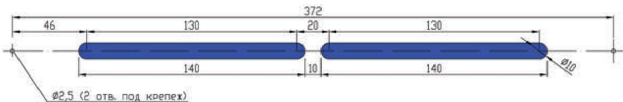
Рекомендуемый размер технологического отверстия в профиле створки:
