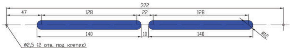
Рекомендуемый размер технологического отверстия в профиле створки:
