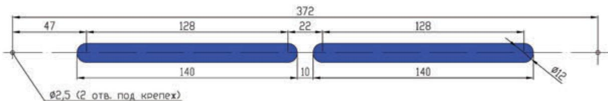
Рекомендуемый размер технологического отверстия в профиле створки:
