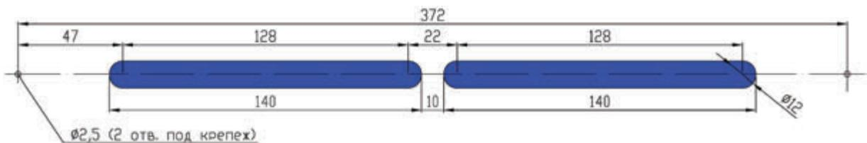
Рекомендуемый размер технологического отверстия в профиле створки:
