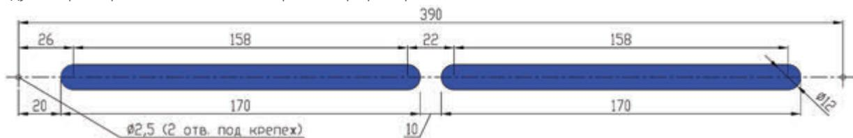
Рекомендуемый размер технологического отверстия в профиле створки:
