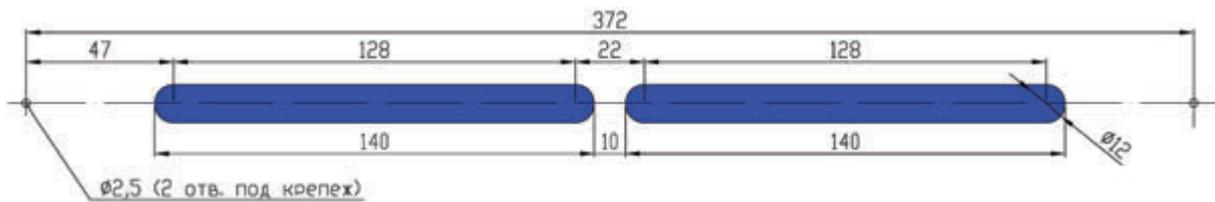
Рекомендуемый размер технологического отверстия в профиле створки:
