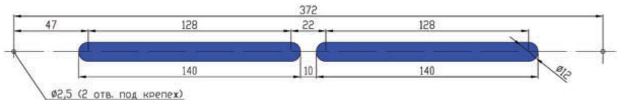
Рекомендуемый размер технологического отверстия в профиле створки:
