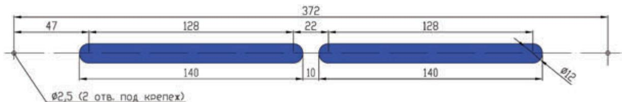
Рекомендуемый размер технологического отверстия в профиле створки:
