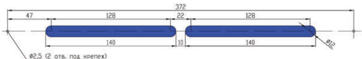
Рекомендуемый размер технологического отверстия в профиле створки:
