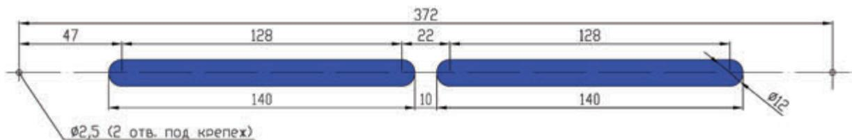
Рекомендуемый размер технологического отверстия в профиле створки:
