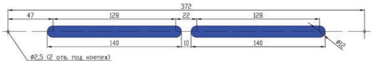
Рекомендуемый размер технологического отверстия в профиле створки:
