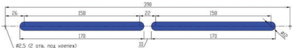
Рекомендуемый размер технологического отверстия в профиле створки:
