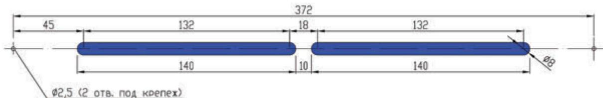
Рекомендуемый размер технологического отверстия в профиле импоста:
