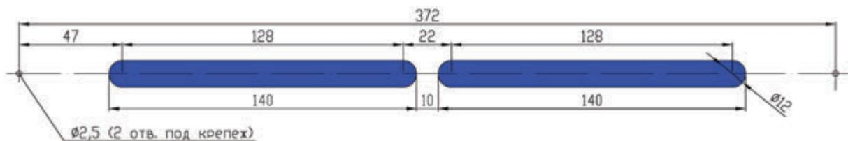
Рекомендуемый размер технологического отверстия в профиле створки:
