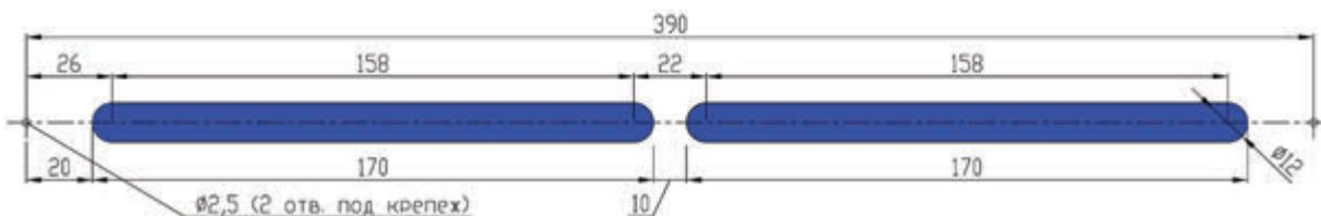
Рекомендуемый размер технологического отверстия в профиле створки:
