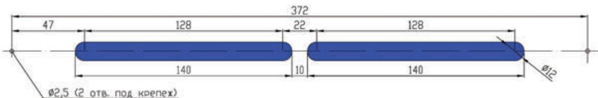
Рекомендуемый размер технологического отверстия в профиле створки:
