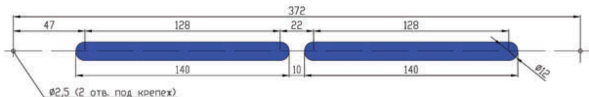
Рекомендуемый размер технологического отверстия в профиле створки:
