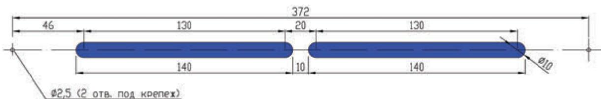
Рекомендуемый размер технологического отверстия в профиле створки:
