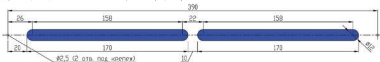
Рекомендуемый размер технологического отверстия в профиле створки:
