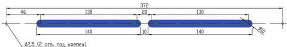
Рекомендуемый размер технологического отверстия в профиле створки:
