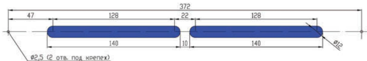
Рекомендуемый размер технологического отверстия в профиле створки:
